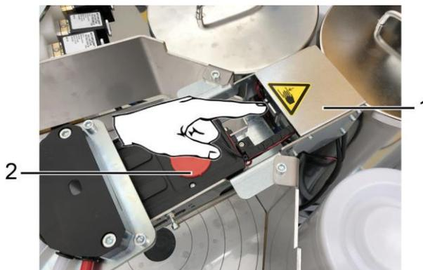
**TECNICO:** Il tecnico autorizzato può rimuovere le protezioni fisse della macchina e accedere alle parti interne dove sono presenti parti in tensione.
